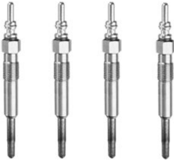
Su tubo incandescente, que se introduce en la cámara de combustión, se calienta en cuanto recibe energía, hasta 1000 °C dependiendo del calentador. Así se calienta también la cámara de combustión. Este proceso que se produce antes del arranque propiamente dicho del motor también se denomina "precalentamiento".
