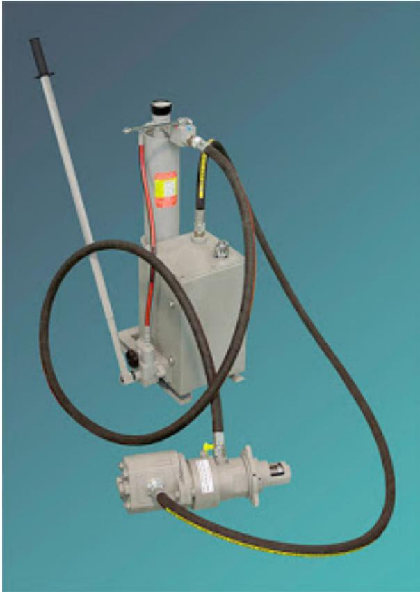
El sistema completo se compone de una bomba manual, un acumulador de pistón conectado a un depósito de aceite, una válvula, un manómetro, dos mangueras de conexión y el motor de arranque oleo-hidráulico equipado con un cilindro hidráulico para mover el piñón Bendix de engranaje con el motor Diesel.
